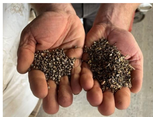
Figure 5 : cas 2.1, à gauche du sarrasin en sortie de trieur optique et de table densimétrique et à droite les écarts de tri en sortie de ces mêmes trieurs (impuretés de densité et de couleurs différentes, i.e. grains vides, pailles, téguments)
