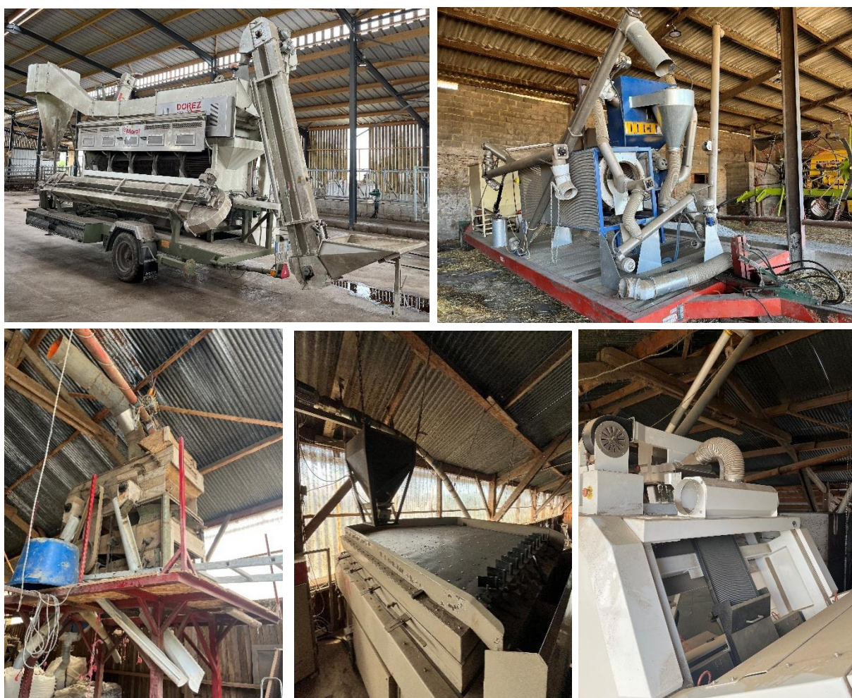
Figure 3 : a) trieur rotatif 5 grilles mobile (en haut à gauche, cas 2.3) ; b) trieur rotatif 2x2 grilles et alvéolaires mobiles (en haut à droite, cas 1.2) ; c) trieur à plat 2 grilles fixe (en bas à gauche, cas 2.1) ; d) table densimétrique (en bas, au centre, cas 2.1) ; e) trieur optique (en bas, à gauche, cas 2.1)
