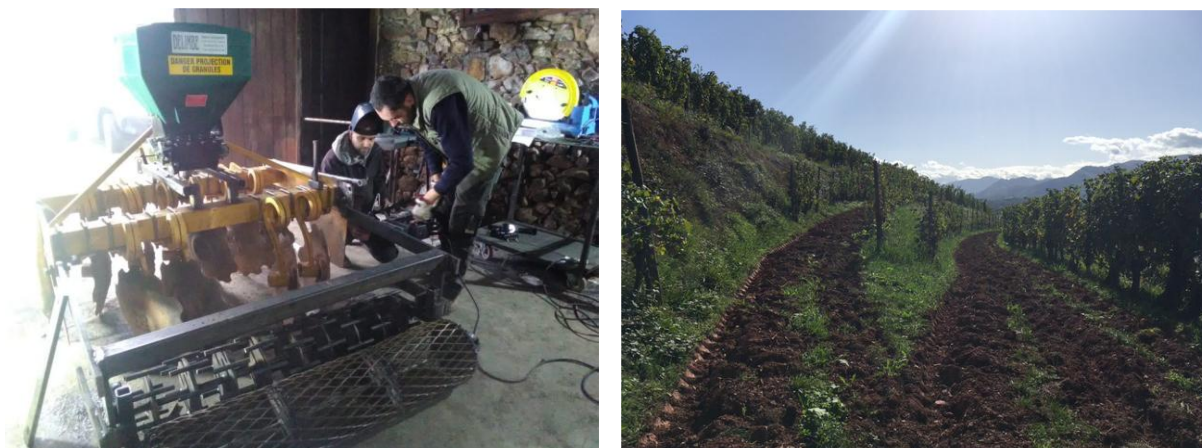
Figure 3. A gauche, photo d'un semoir à disque Photo d'un cover crop modifié (crédit Atelier Paysan). L'ajout d'un semoir petites graines microgranuleur "Delimbe" (en vert), d'un rouleau et d'une cage de hersage, permet de travailler le sol et de semer les interrangs de vigne en un seul passage. A droite, photo d'une vigne en terrasse (crédit P. Malanski)
