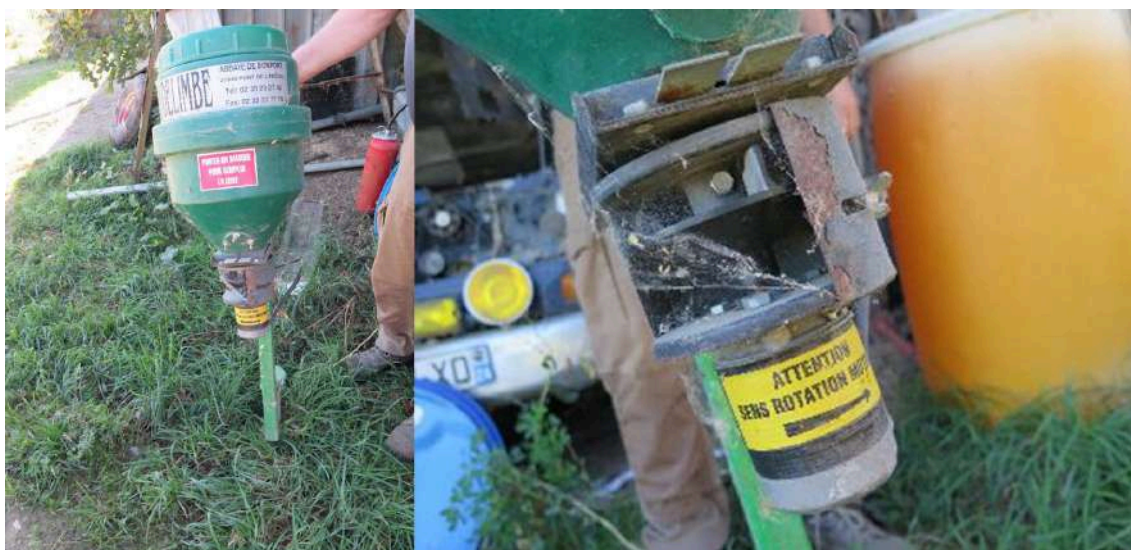
Figure 3 : Illustration d'un équipement agricole réutilisé, à savoir un microgranulateur électrique initialement conçu pour épandre des engrais et réutilisé ici pour semer des cultures de couverture. Crédit : E. Fouillet, INRAE.
