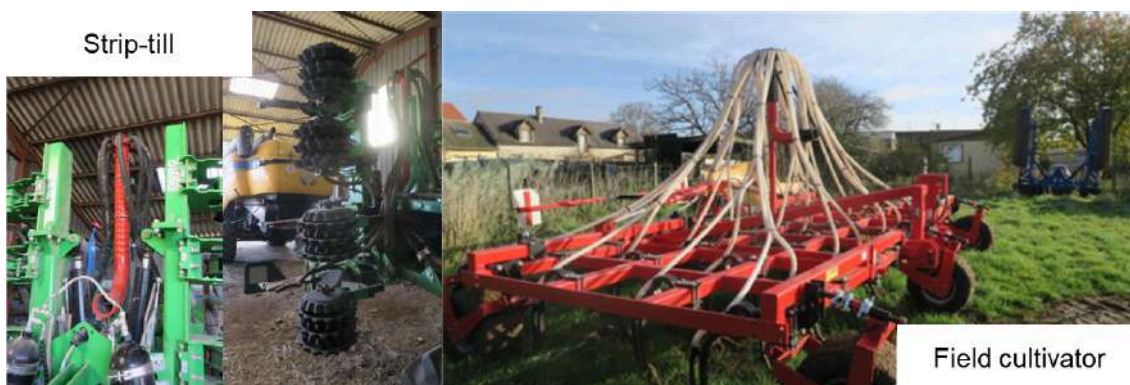
Figure 5 : Illustration d'un équipement agricole combiné modifié permettant de semer deux espèces à des profondeurs différentes en un seul passage. Crédit : E. Fouillet, INRAE
