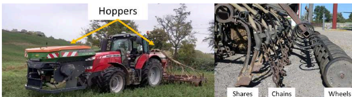
Figure 6 : Illustration de la construction d'un semoir sans labour permettant de semer plusieurs espèces simultanément. Crédit : E. Fouillet, INRAE
