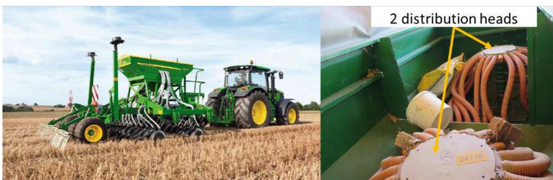
Figure 4 : Illustration d'un équipement agricole bricolé pour semer deux espèces simultanément. Crédit : E. Fouillet, INRAE.
