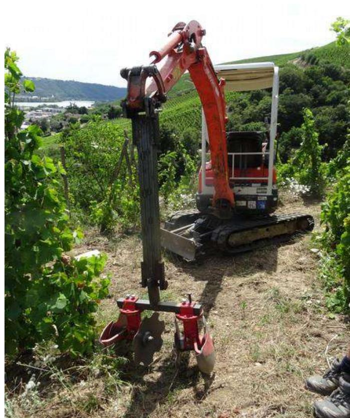
Figure : Mini-pelle de chantier adapté aux travaux agricoles de pente, source : [L'atelier paysan](#)
