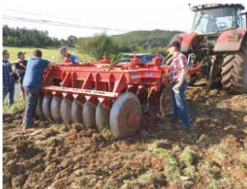
Avec un châssis renforcé et des disques de 92 cm de diamètre, le poids de l'outil atteint 9 tonnes.
